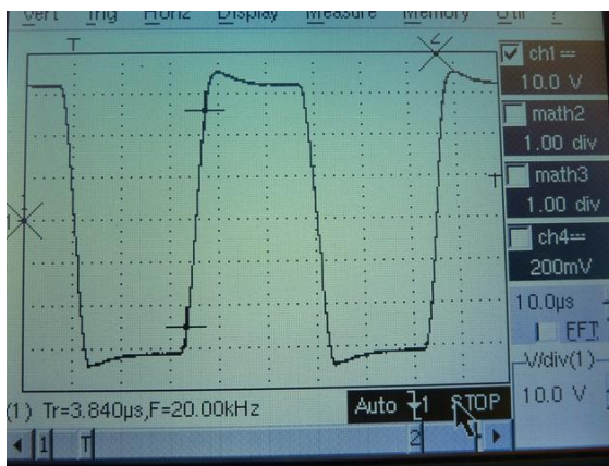
PMA-A100: square 20kHz do zátěže 80hm (repro), amplituda cca 1,5V resp. cca 30V
